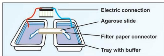
Fig. 54.1. Electrophoresis apparatus
