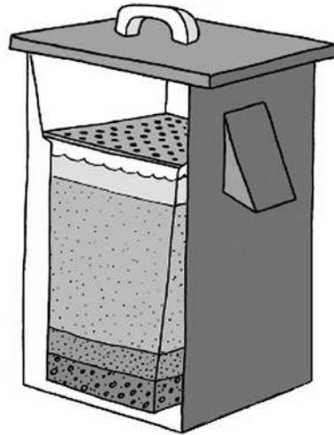
Figure 5.6. A biosand filter<sup>196</sup>
