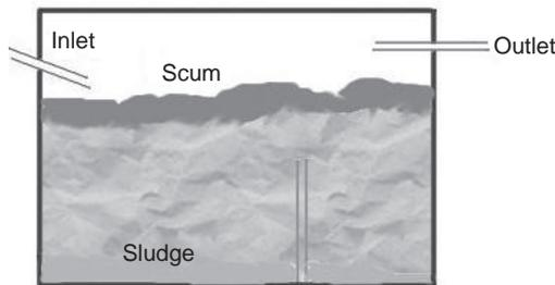
Figure 5.19. A septic tank<sup>229</sup>
